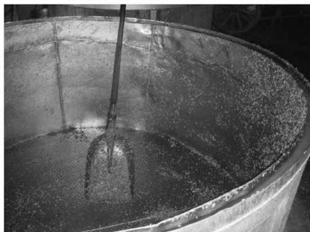
写真 18 蒸留器の底は金属孔目になり，蒸気が吹き上がる。蒸留が終わり，蒸留粕を取り出した蒸留器内部
