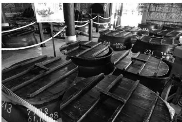
写真8 仕込室、仕込み甕は温度管理のために地中に3分の2程埋めて使用する
