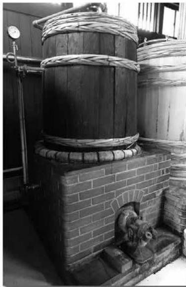
写真 13 蒸気発生装置（ボイラー使用）
