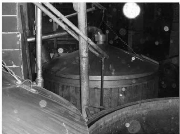
写真 17 金属製の大型円形の単式蒸留器，醪の出し入れは三角錐型の蓋を移動させて行う
