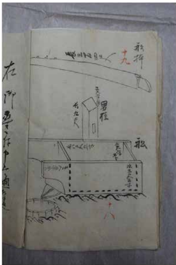
写真5 船（槽（ふね）ともいう、搾り機）、船棹（酒造業ではね棒ともいう）と男柱（支柱）は船の圧搾の支点
