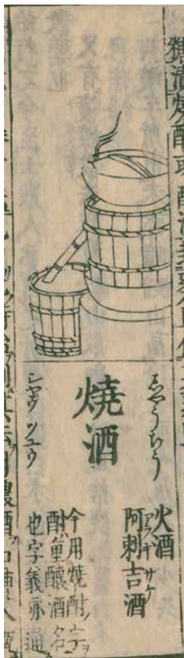
図4 焼酎（倭漢三才図会巻105、造醸類より）、蒸留装置として上から焼酎上釜、甑、下釜、とひ、左側に焼酎入桶が描かれている。国立国会図書館デジタルコレクション（インターネット公開）
