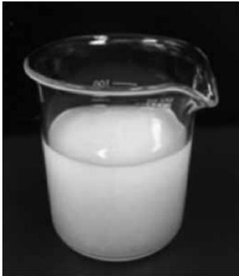
図1 部分解繊セルロースのスラリーの外観
