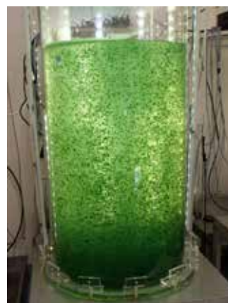
図4 ノストコプシスの人工栽培 (200L容培養リアクター)
