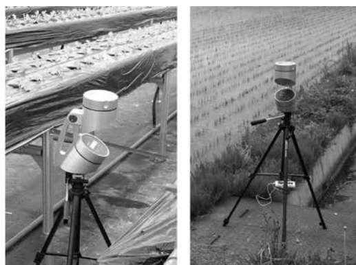
図2 エアースAMPLER・MAS100による浮遊糸状菌のサンプリングの様子（左：栽培施設内、右：屋外）
