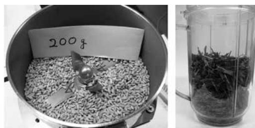
写真3 粗米200g (SC-01S) と番茶50g (MAG-MB) の装填時の概観
