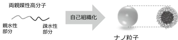
図2 水中における両親媒性高分子の自己組織化によるミセル構造 (ナノ粒子) の形成
