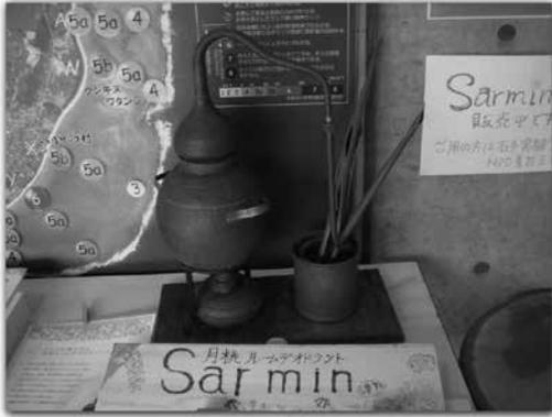
写真 21 月桃から精油を得るための蒸溜器
