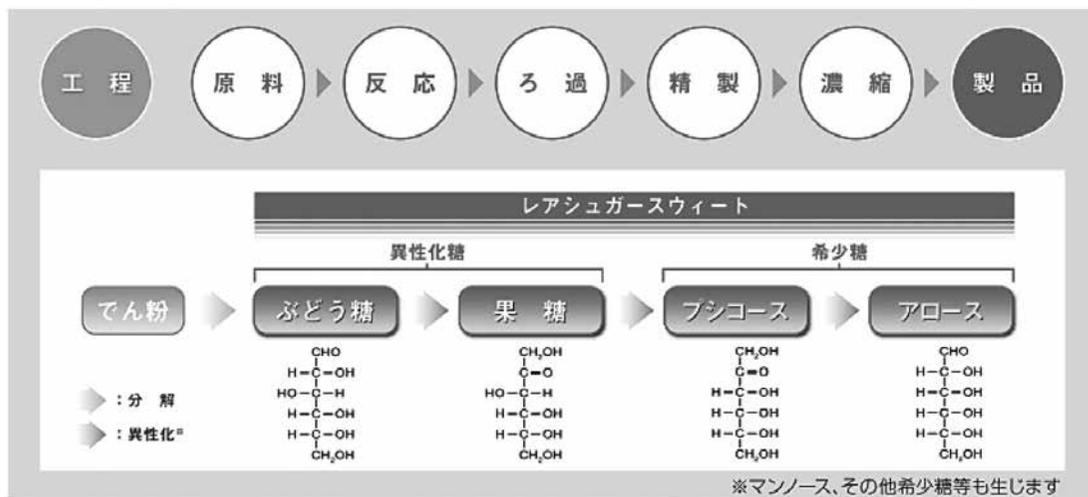
図2 希少糖含有シロップ（レアシュガースウィート）の製造工程とその特徴
