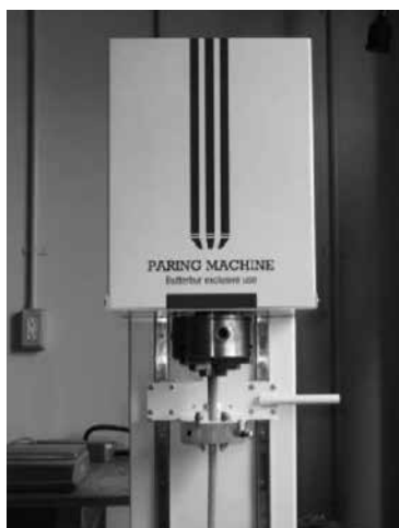
図19 試作したフキ用皮むき機
