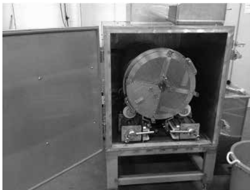
図 4 酢酸ガスの大型処理装置
