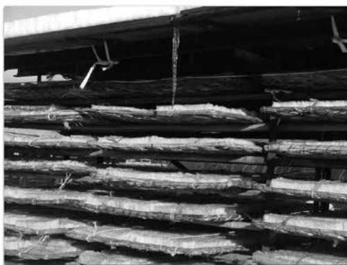
写真 29 簀棚（櫛棚、よせ棚）での乾燥（天日）
