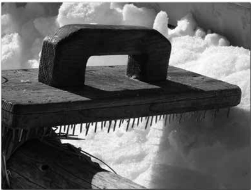
写真 25 釘を差し並べた「注射器」
