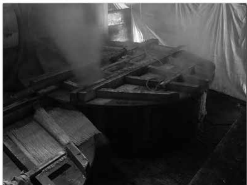
写真 15 厚い木製の釜蓋をした寒天釜
