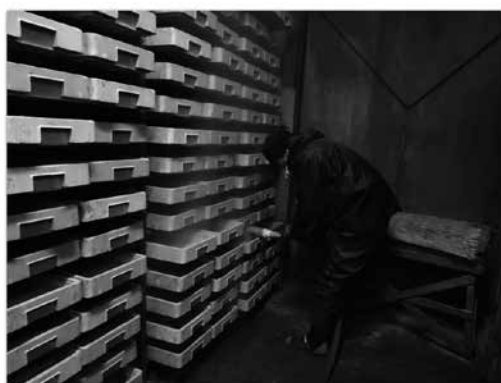
写真 20 諸蓋に濾液を注ぐノリつぎ作業
