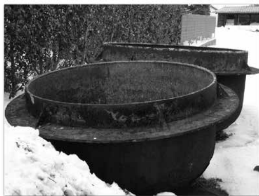
写真8 寒天工場跡に残る直径2m余りの大小二つの鉄製寒天釜(羽釜)
