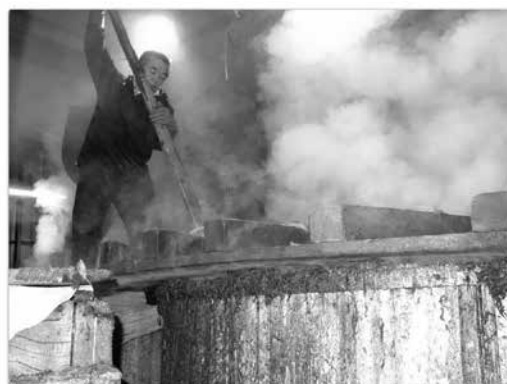
写真 13 煮沸棒立て作業①、佐藤さんは全身を使い攪拌棒でクサを混ぜる
