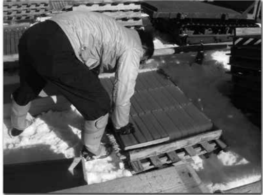
写真 24 寒天形枠に沿って改良台に生天を並べる
