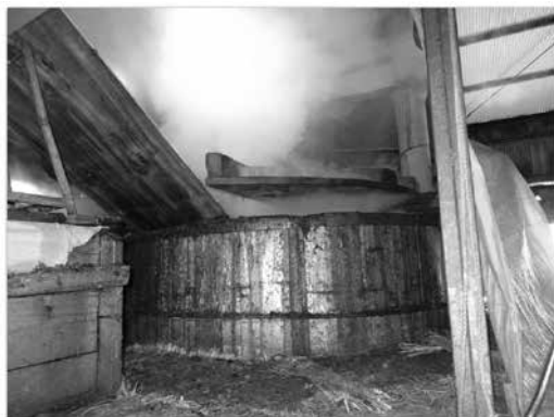
写真 12 原藻は戸板（左）の上を滑らせて、寒天釜（上部は木製の胴）に投入
