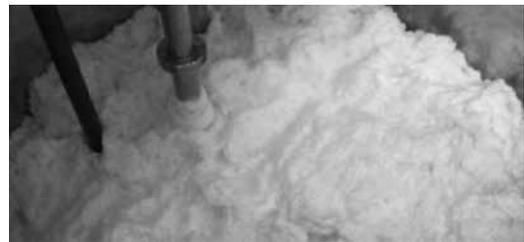
図3 GABA 合成反応中の反応槽上部の発泡現象
