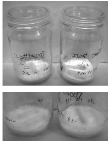
図7 25℃でエリノギに暴露中のシリカンバ木片(上)とトドマツ木片(下)の様子
