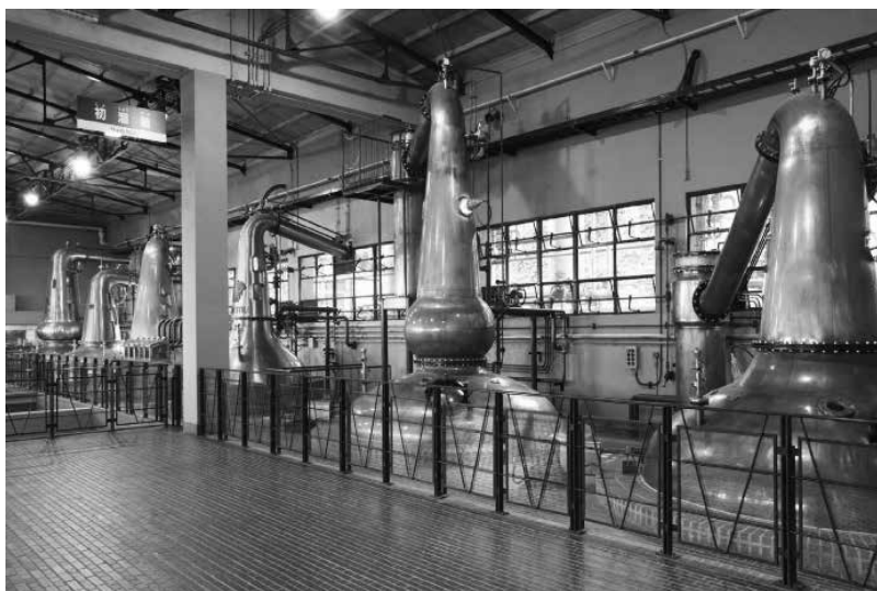
図 11 蒸留所のポット・スチル (サントリー山崎蒸留所)
