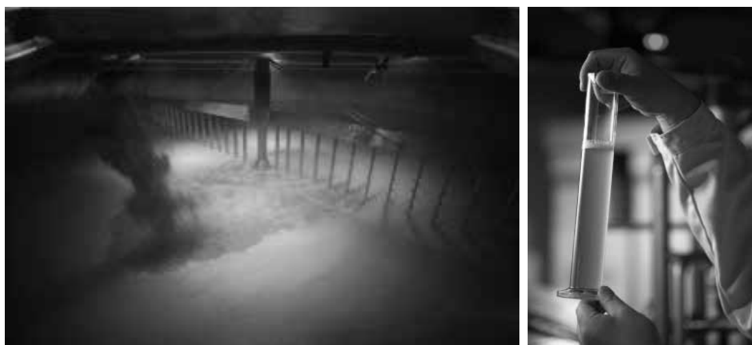
図6 糖化中の糖化槽内部の様子(左)、糖化麦汁(右)
