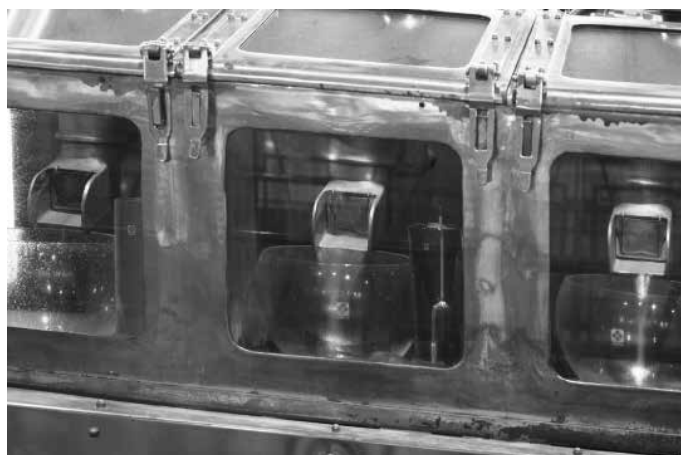
図13 単式蒸留器から出てくるウイスキー蒸留液
