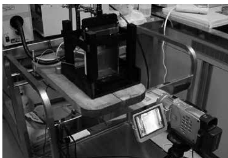
図4 感温液晶を用いた内部温度分布のリアルタイム観察システム
