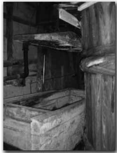
写真12 压榨機 (旧山吉醤油)、下の槽を舟、上に鉄の蓋が見える
