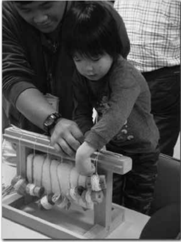
写真 24 簀編み台を使って海苔簀を編む
