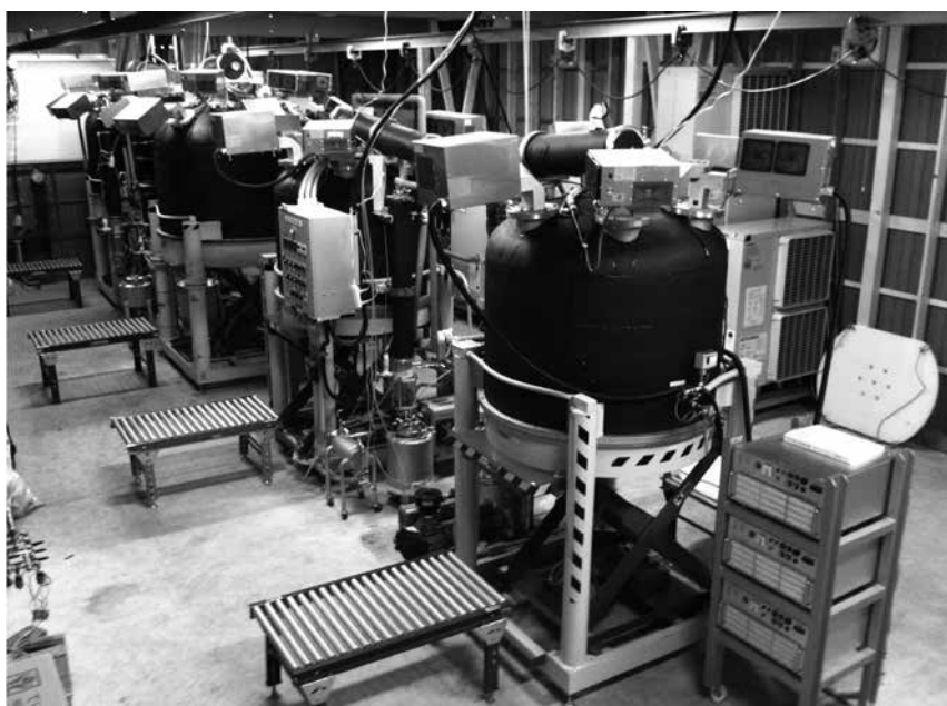
図 13 減圧式マイクロ波水蒸気蒸留法による精油の大量抽出
