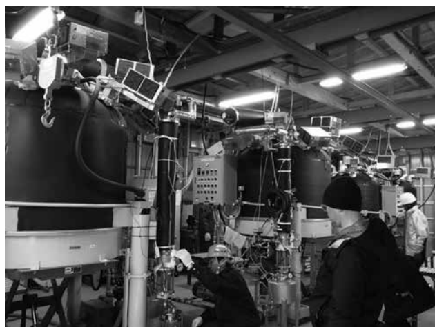
図 13 減圧式マイクロ波水蒸気蒸留法による精油の大量抽出
