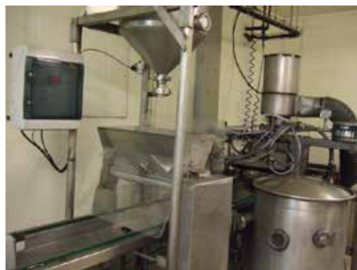
写真 12 塩や木炭をまぶす機械。チーズを載せた網ごと機械のレールにのせ移動させると、上から定量の塩や木炭がふりかかる仕組み。
