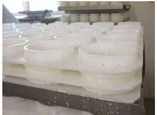
写真10 型を一時的にかさ上げるための、継ぎ足し用の筒。
