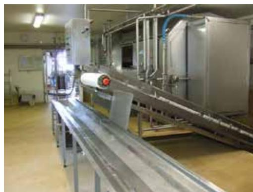
写真2 ロックフォール製造用バット(右奥)とベルトコンベア2基。バットは扉が閉まる閉鎖式であった。ここから凝乳の粒がベルトコンベア(右)上に移され昇りきると、ベルトコンベア(手前)上に落ちる。ここから凝乳粒は手前側へ移動し、終点で型詰めされる
