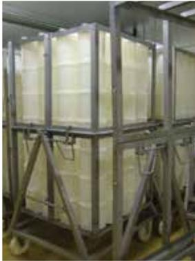
写真3 台車に積んだロックフォールの型。ロックフォールの脱水時也是这样に積み、台車に取り付けた縦長のケースに固定する。するとケースごと台車上で上下反転できるため、一つずつ反転する手間を省ける。
