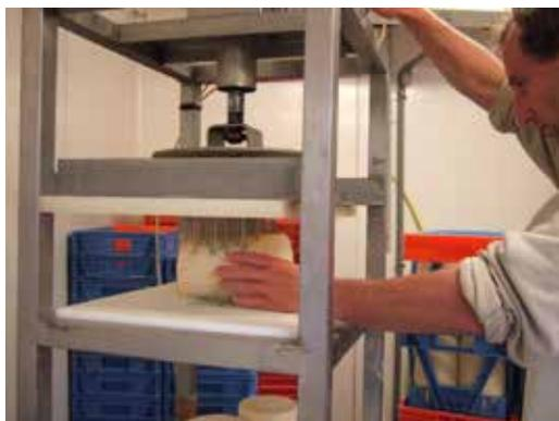
写真6 穴を開ける手動の機器。これはオーヴェルニュ地方で見た他のチーズに対するものだが、針の構造が良くわかるので参考までに挙げておく。
