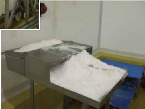
写真4 加塩する台、粗塩、簡易計量用の柄杓
