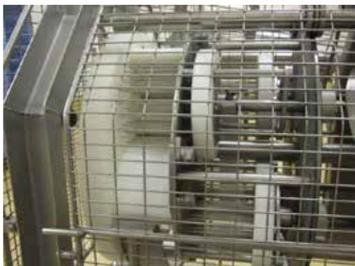
写真5 穴を開ける機器。ロックフォールを送り込むと自動で穴を開ける。
