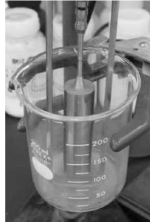
図 6 回転粘度計による粘度測定
