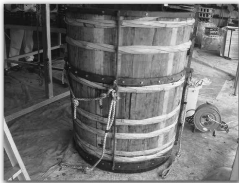
写真4 蒸し桶(底がすのこ状で、大鍋の上に乗せて茶葉を蒸し上げる)
