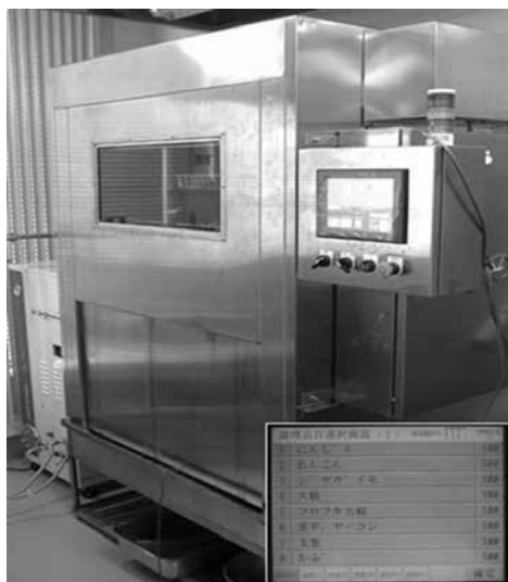
図1 ソフトスチーム加工機の外観と選択画面
